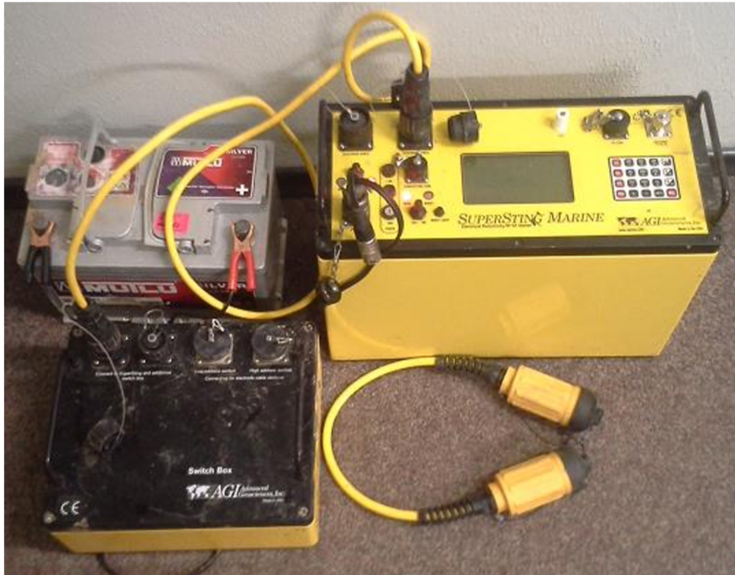
1 pav. AGI SuperSting įranga: SuperSting varžų tomografas ir komutatorius.
